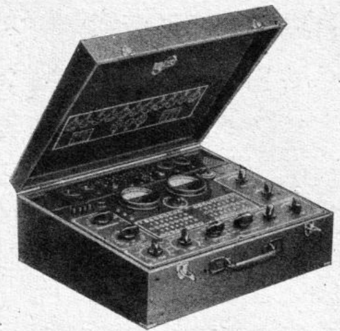
Bild 1. Ein Blick auf die Frontplatte des Röhrenmeßgerätes „Tubatest-M 1“ läßt die übersichtliche und zweckmäßige Anordnung der Bedienungselemente erkennen. In der Mitte befinden sich sechs Steckerleisten für die Spannungsabführung an die Röhrenelektroden. Darüber sind Strom- und Spannungsmesser angeordnet. Ganz oben sieht man die Röhrenfassungstafel mit den beiden Glühlampen L1 und L2. Unten haben links die Gitterspannungsregler mit der Vakuum-Prüfzelle und rechts die Anoden- und Schirmgitterspannungsregler Platz gefunden. In der Mitte sieht man den Prüfschalter und den Spannungsschalter. In der Mitte des Meßgerätes wurden auf der linken Seite Heizumschalter und Heizspannungsregler angeordnet. Auf der rechten Seite befinden sich Netzregler und das U g4 — Potentiometer
